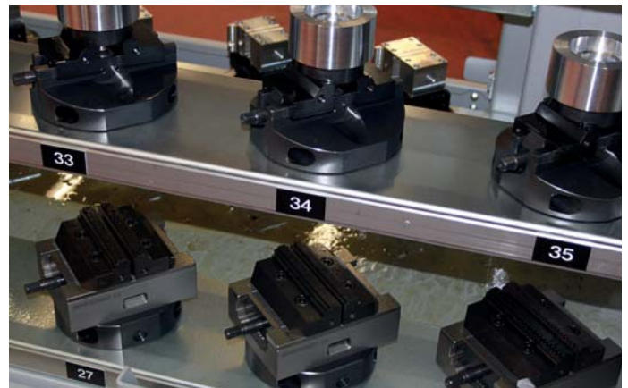
Eine Auswahl an chaotisch im Werkstückspeicher P60 platzierten Werkstück-Spanneinheiten auf Basis der 56 Stück Zentrischspanner C1 und C2 und mit verschiedenen Werkstücken belegt.
