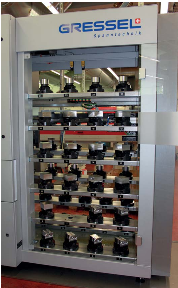
Die Frontseite (maschinenseitig) des mit einem 5-Achsen-Bearbeitungszentrum DMU 60 eVo gekoppelten Werkstückspeichers P60 von Gressel, der wiederum mit insgesamt 56 Werkstück-Spannsystemen vom Typ Zentrischspanner Gressel C1 und Gressel C2 bestückt ist.
