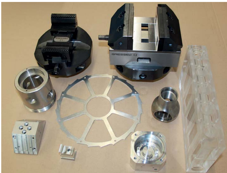
Die Zentrischspanner Gressel C1 und Gressel C2 vor einer kleinen Auswahl an typischen Präzisionsteilen, wie sie bei Franz Künzli AG bearbeitet beziehungsweise gefertigt werden.
